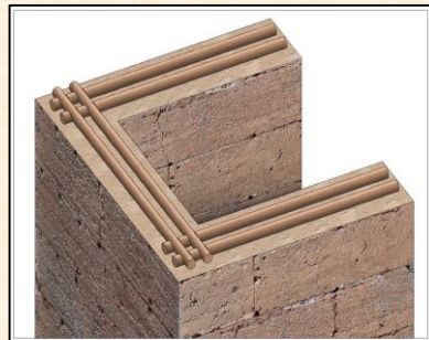
Vigas de madera que arman una de las hiladas de la torre del recinto de Hornos de Segura (Márquez Bueno, 2018)
